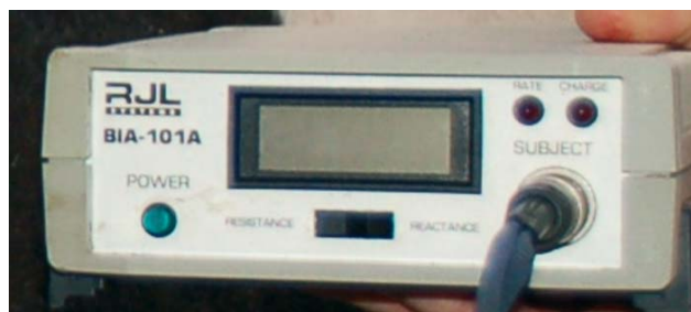
Figuur 1. De BIA-101-analyser (RJL Systems).
